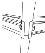
Posicione as barras que compõem a base da grade inferior em cada furo do tubo e parafuse-as.
