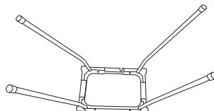
Posicione o suporte (6) virado para cima em uma superfície plana e encaixe os tubos montados.
