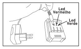
3. Conecte o carregador da bateria a uma tomada elétrica padrão. IMPORTANTE: Uma recarga completa demora de 3 a 4 horas.
